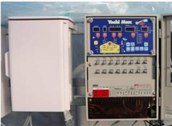
図1 開発した環境制御コントローラ YoshiMax.
