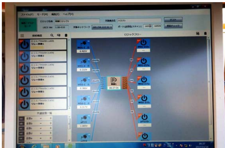
写真2 本研究で開発されたUECS準拠アプリケーションソフトウェアである制御ロジック開発ツールの動作画面例
