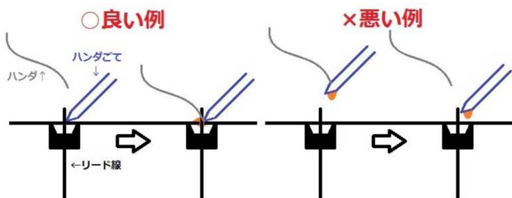
※下の図ではハンダ付けの失敗例を図解しています。この様な形状になった場合、上手く付いていないので、修正方法を参照してください。ハンダを取り除けない場合は、ハンダを温めなおして、基板を持ち、冷めないうちに机に縦（平たい面の方ではなく、側面が机に当たる様に）に叩き付けてください。熱したハンダのみ、落ちます。この時、基板を傷つけないようにしてください。
