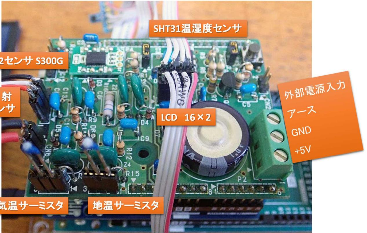
基板へのセンサ取り付け状態 (CO<sub>2</sub>と日射センサは基板の印刷の1番が赤線になります)
