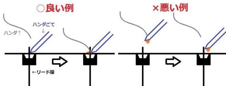
下の図ではハンダ付けの失敗例を図解しています。このような形状になった場合、上手く付いていないので、修正方法を参照してください。ハンダを取り除けない場合は、ハンダを温めなおして、基板を持ち、冷めないうちに机に縦（平たい面の方ではなく、側面が机に当たる様に）に叩き付けてください。熱したハンダのみ、落ちます。この時、基板を傷つけないようにしてください。
