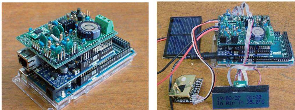
低コスト UECS 気象計測ノードの基板の積層方法と、センサ等の取付状況
