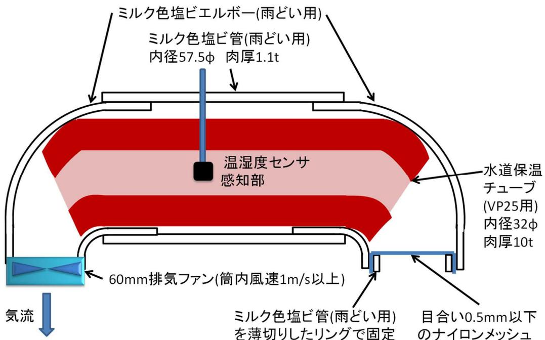
温湿度計測用の計測筒の工作例
