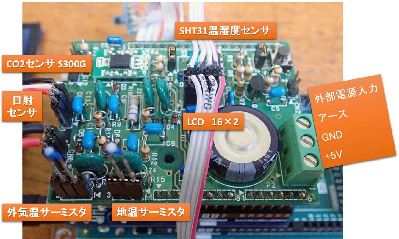
基板へのセンサ取り付け状態 (CO<sub>2</sub>と日射センサは基板の印刷の1番が赤線になります)
