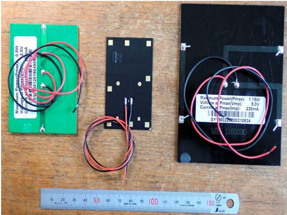
電線の赤が+端子、黒が-端子。左から、廃品番の SUNYOO solar SY-M0.5W、SHARP LR0GC02、SUNYOO solar SY-M1.15W
